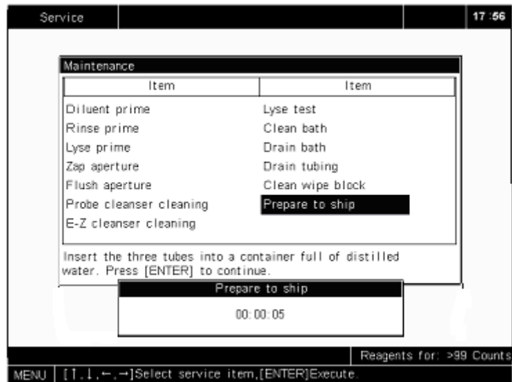
Abbildung 10-32 Waschen des Analysators
